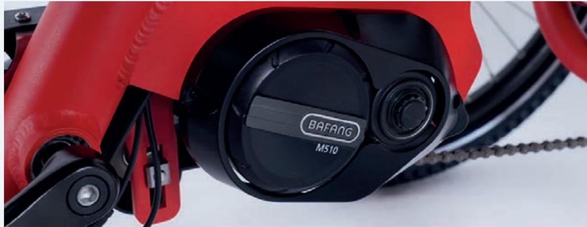
Le moteur pédalier est un moteur plus technologique qui a 2 différences majeures en comparaison des moteurs roues plus classiques. D'une part il intègre un capteur d'effort afin d'adapter sa puissance à l'effort fourni par l'utilisateur et d'autre part, sa puissance passe par la transmission et donc par le dérailleur ce qui a pour effet d'optimiser la puissance fournie aux roues en fonction de la vitesse à laquelle vous roulez. Cependant, il faut être conscient qu'avec ce type de
